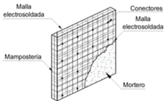
Figura 42: Sistema de mampostería revestida con malla electro-soldada y recubierta con hormigón ó mortero
