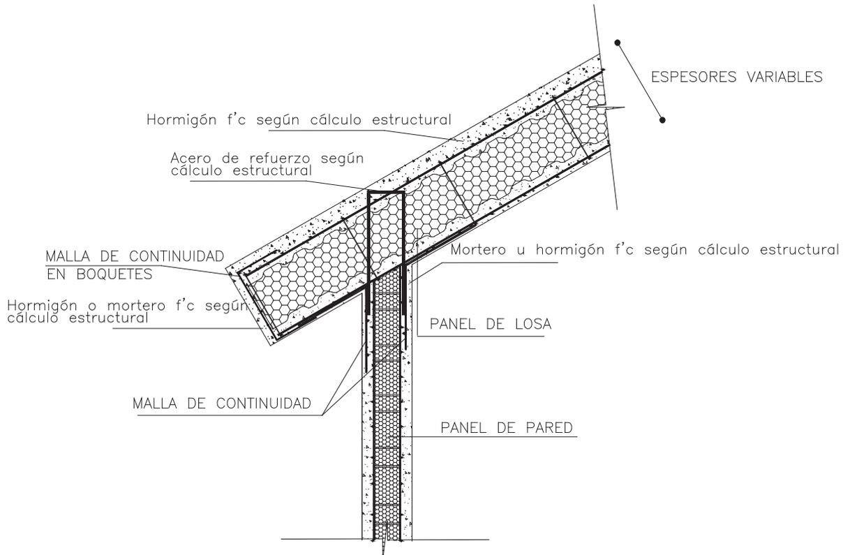
DETALLE UNIÓN MURO-LOSA
