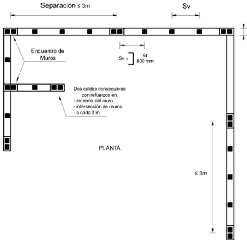
Figura 14: Planta típica de muros reforzados, ubicación del refuerzo vertical
