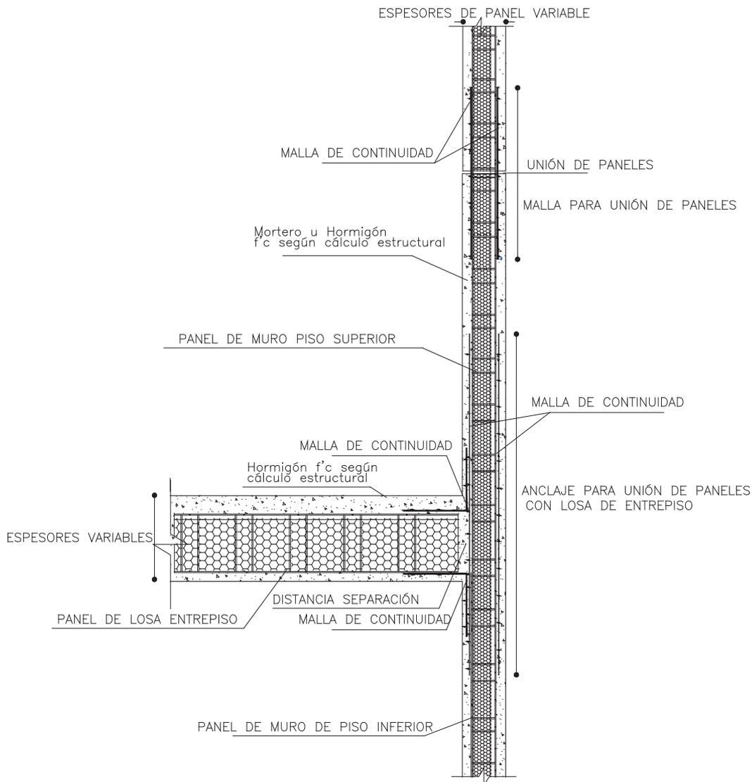
DETALLE UNIÓN MURO CONTINUO-LOSA
