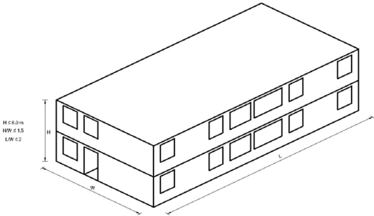
Figura 29: Requerimiento estructuras simples. Proporciones geométricas
