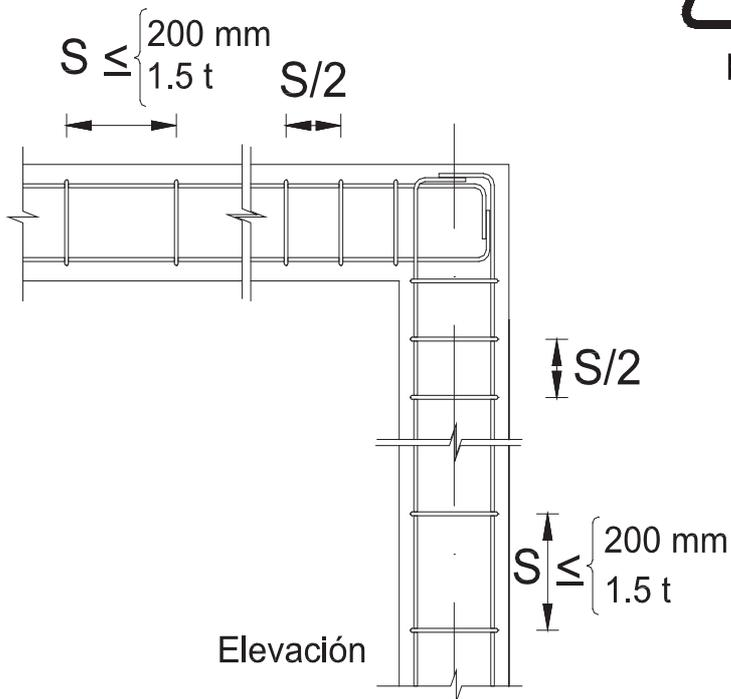
Figura 35: Detallamiento para columnas de confinamiento
