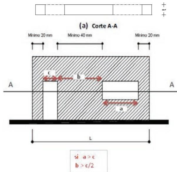
Figura 7: Disposición de aberturas en un muro
