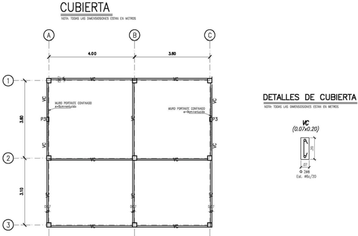
*Nota: Se debe tener presente que estas son vigas de amarre de cubierta. La cubierta en sí estará apoyada sobre los pericos mediante perfiles metálicos.*
