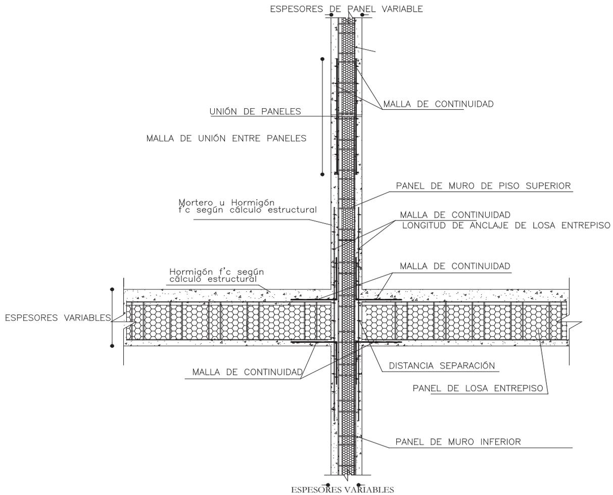
DETALLE UNIÓN MURO CONTINUO-LOSA
