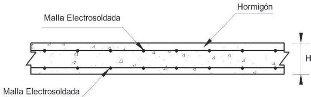
Figura 45: Losa maciza de hormigón
