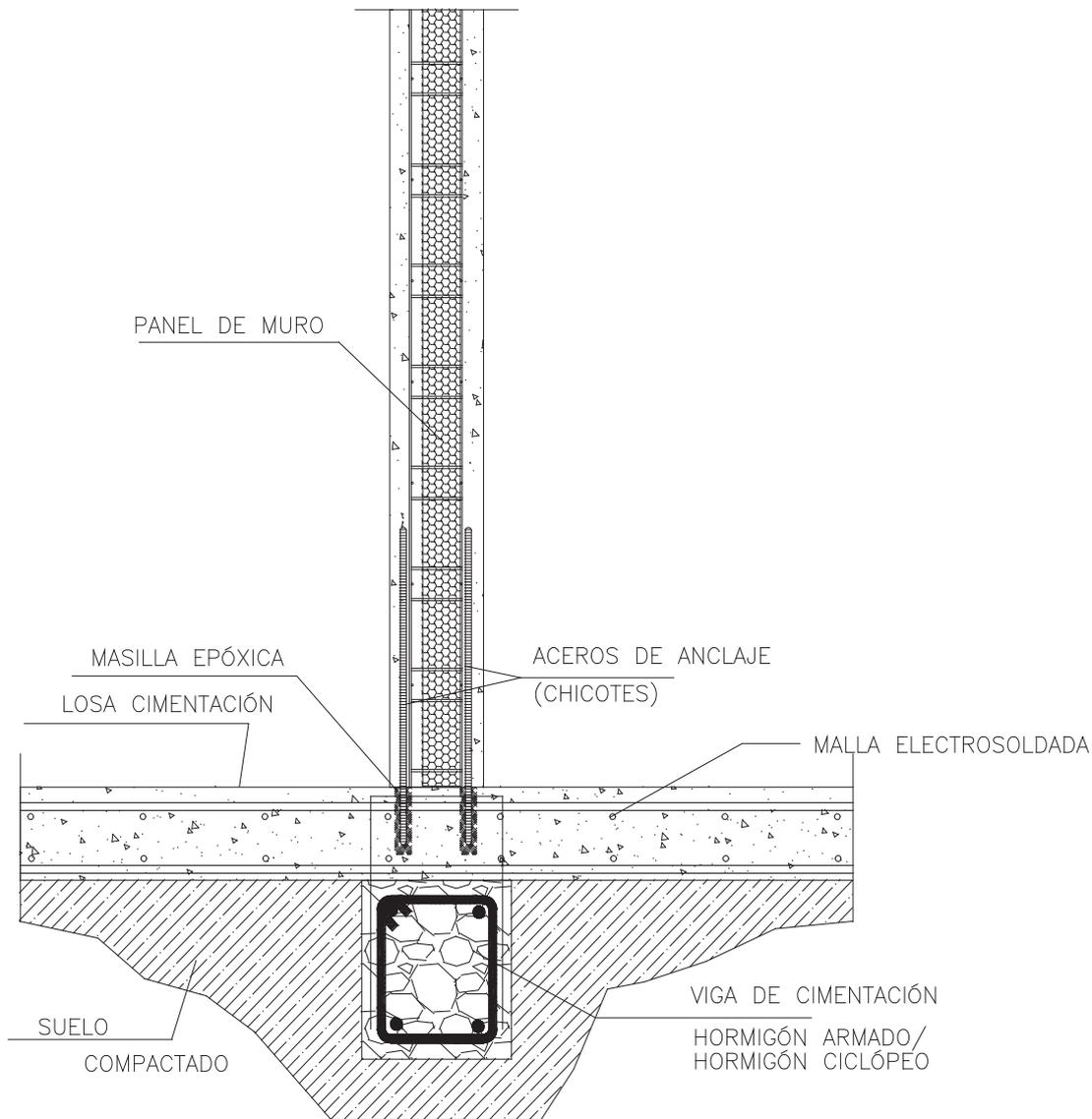
Figura 48: Esquema típico de anclaje
