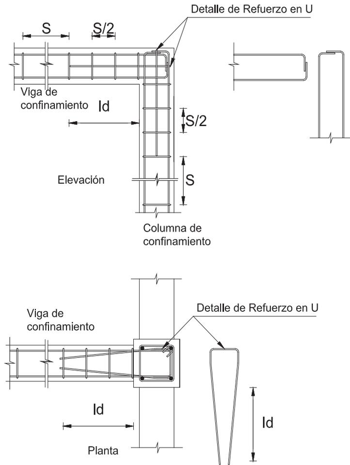
Figura 36: Detallamiento para vigas de confinamiento (riostras)
