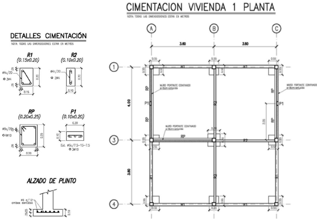
*Nota: Solo aplica para suelos de relleno compactado de por lo menos 1 metro de espesor.*
