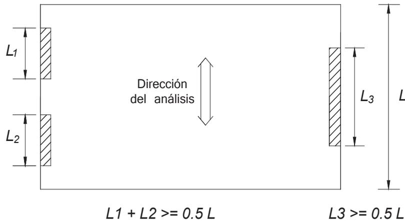
Figura 37: Disposición de muros perimetrales
