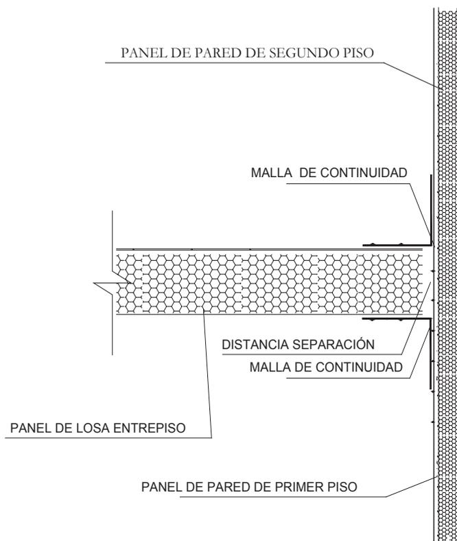
Figura 53: Instalación de panel de losa lateral al muro
