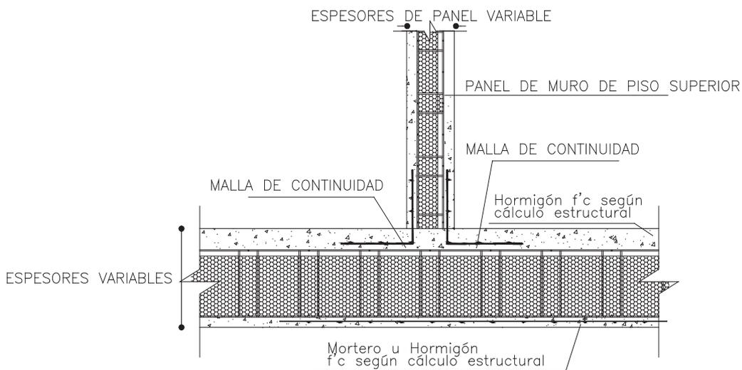
DETALLE UNIÓN LOSA-MURO SUPERIOR
