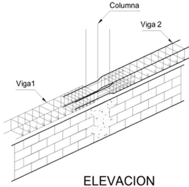
Figura 32: Construcción de la viga de confinamiento ([Brzev, 2008](#))
