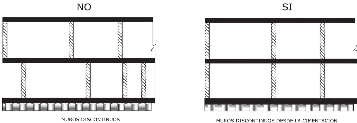
Figura 2: Continuidad en elevación para edificaciones
