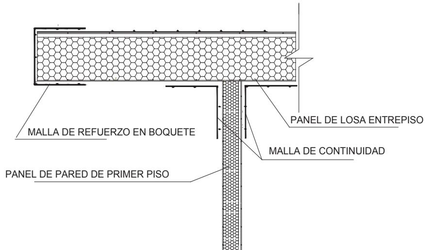
Figura 52: Instalación de panel de losa sobre muro
