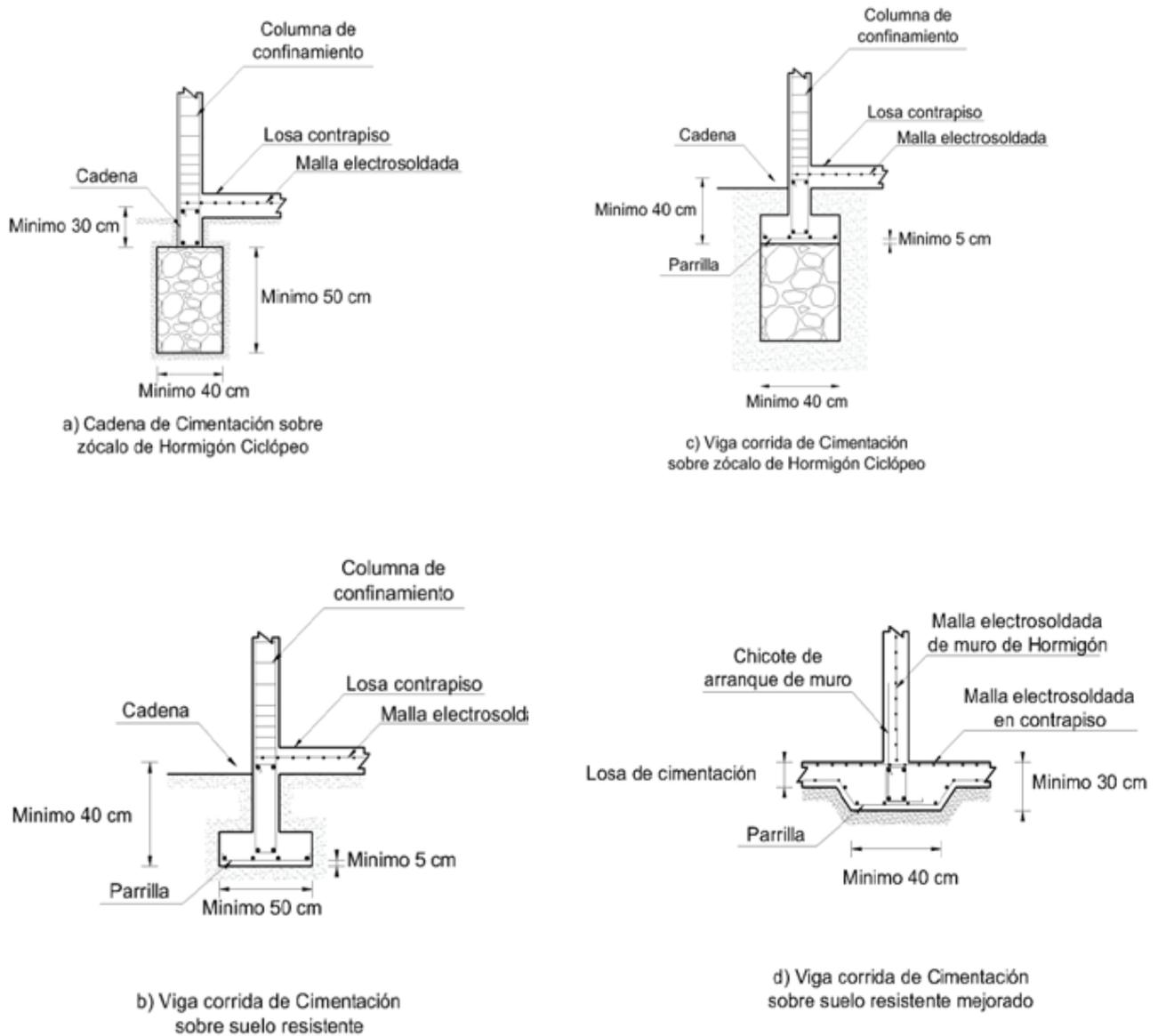
Figura 10: Tipos de cimentación en muros portantes
