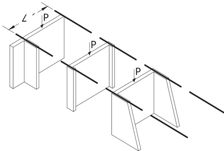
Figura 20: Restricción a la deformación lateral
