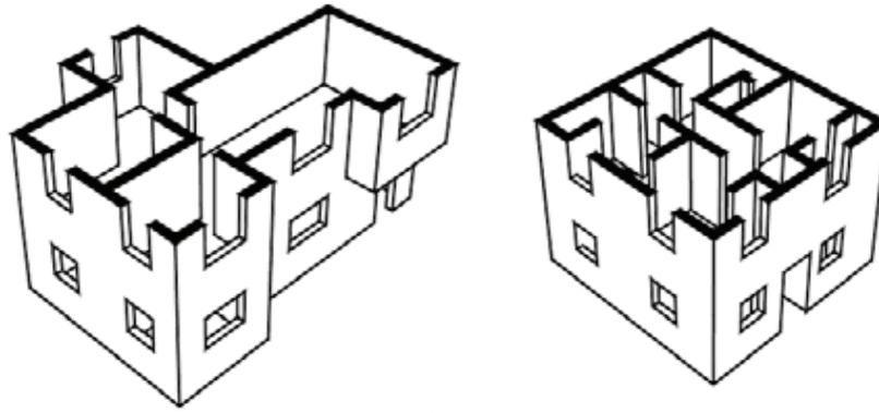
Figura 6: Disposición de muros portantes
