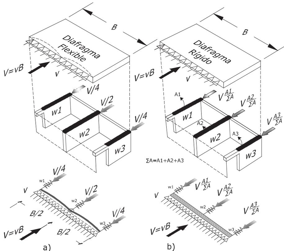
Figura 13: Distribución de las cargas laterales en edificaciones
