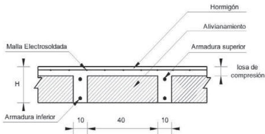
Figura 44: Losa alivianada con nervios en dos direcciones
