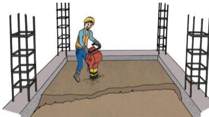
Figura 50: Suelo natural compactado
