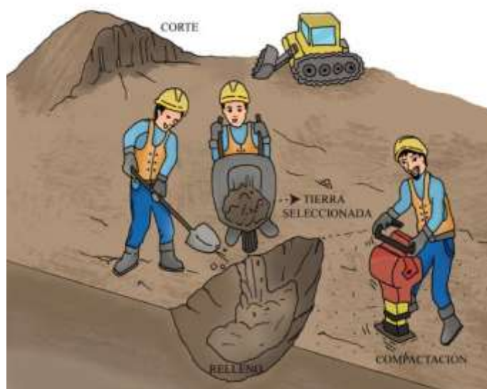
Figura 25: Nivelación del terreno: corte y relleno
