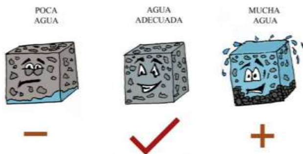
Figura 17: La cantidad de agua justa produce el mejor hormigón
