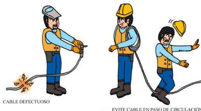
Figura 133: Revisión de cables y conexiones de soldadora
