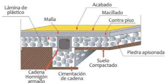
Figura 49: Detalle de contrapiso
