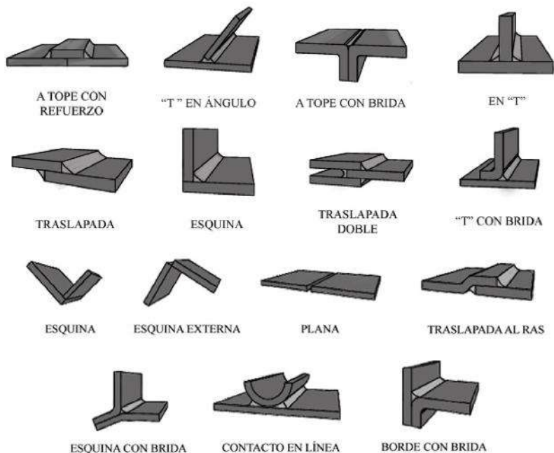
Figura 126: Ejemplos de juntas comunes realizadas con SMAW-GMAW
