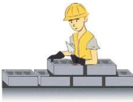
Figura 65: Colocación de bloques trabados
