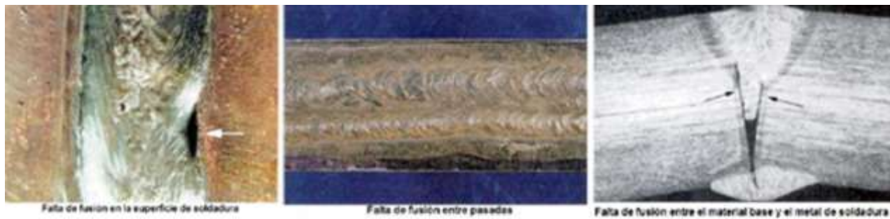
Figura 130: Defectos en la soldadura: fusión incompleta
