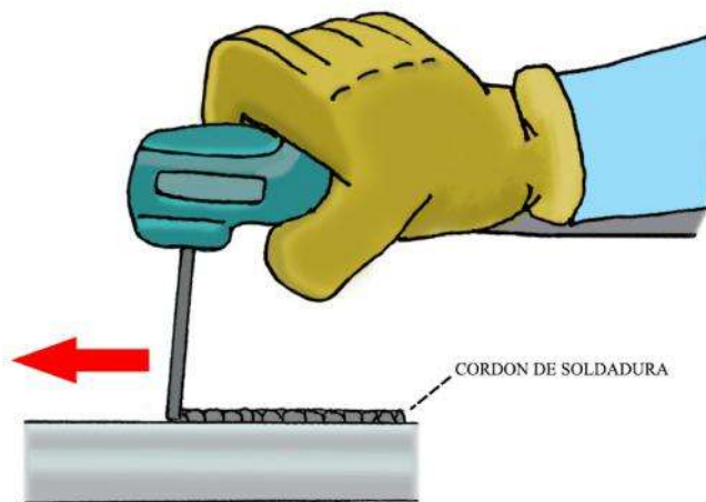
Figura 115: Soldadura de cordón
