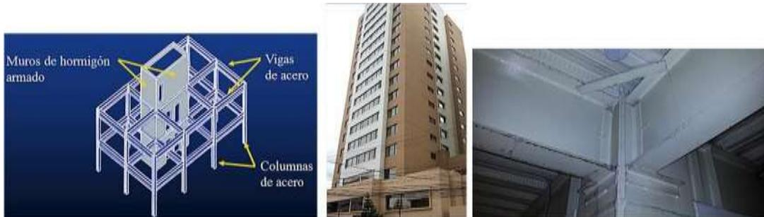
Figura 124: Tipo de sistema estructural: Pórtico de acero doblado en frío (S3).
