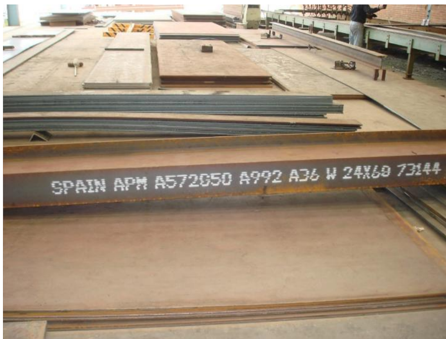
Figura 8. Perfil laminado en caliente que cumple con varias especificaciones ASTM
